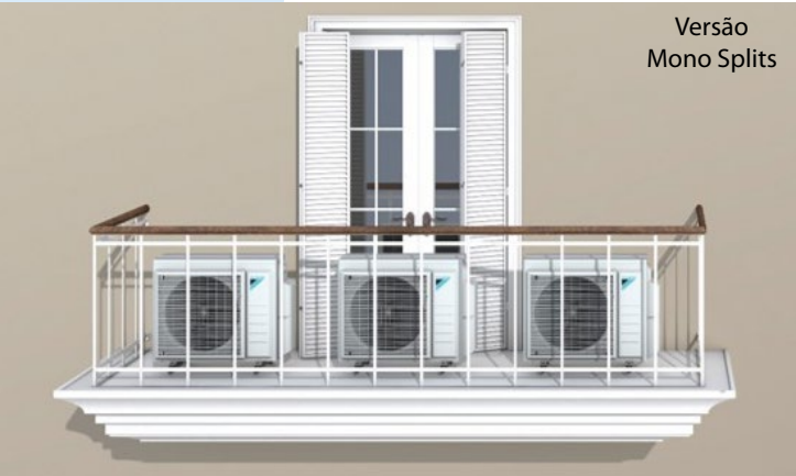
Instalação split em par para climatizar três divisões com ar condicionado
