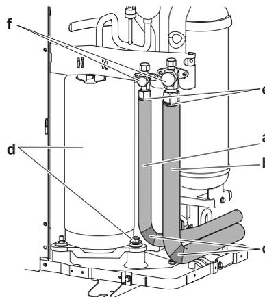
5 Se a unidade de exterior for instalada por cima da unidade interior, cubra as válvulas de corte (f, ver acima) com vedante para evitar que a água condensada nas válvulas de corte vá para a unidade interior.
