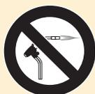
NUNCA retire o tubo estrangulado com um ferro de soldadura.
