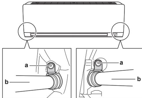
a Parafuso de fixação do isolamento
