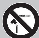
Nunca retire o tubo estrangulado com um ferro de soldadura.
