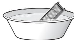
4 Depois de lavar, sacuda o excesso de água e seque o filtro à sombra. NÃO torça o filtro ao retirar o excesso de água.
